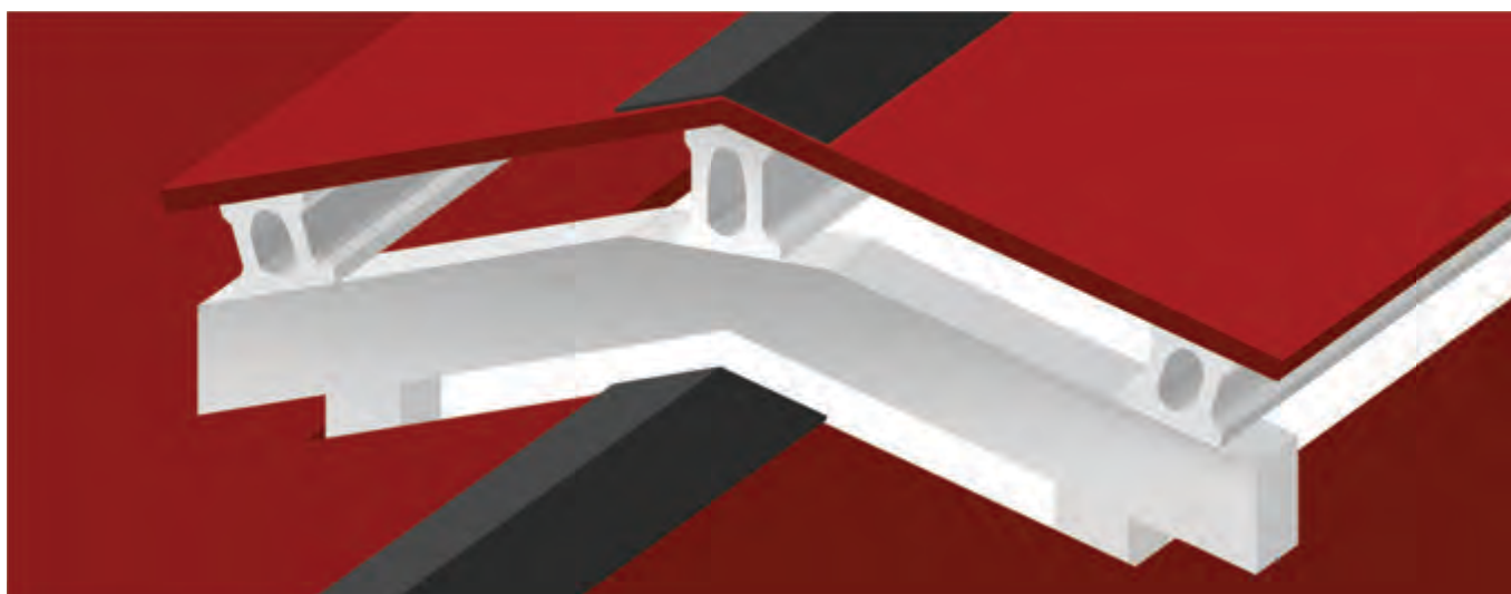
Pórtico de ventilación con apoyo de 2 viguetas
