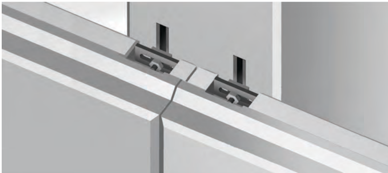
Apoyo panel en pilar con ménsula metálica
